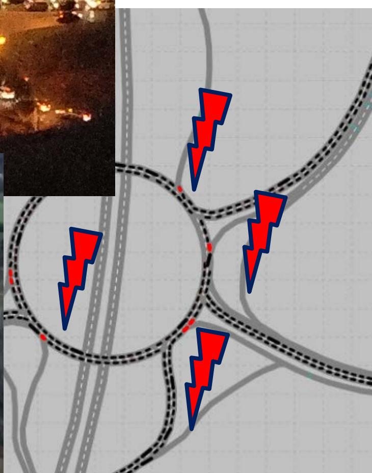
La réduction de la chaussée annulaire de 3 à 2 voies provoque un blocage systématique des sorties. Ce phénomène a pu être documenté par des simulations, la pratique en témoigne!
