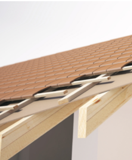
Toiture avant rénovation (sans isolation)
